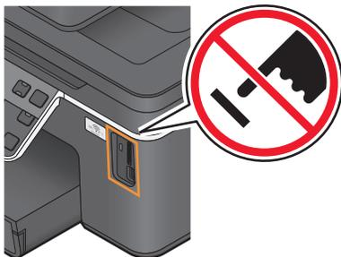
**警告—可能的损坏：**当正在打印、读取或写入存储设备时，请不要触摸任何电缆、任何网络适配器、任何接口、存储设备或图中所示的打印机区域，否则可能会发生数据丢失。
