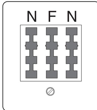
将打印机连接在任意的 N 插口上。
