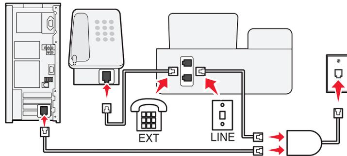
数字用户线路(DSL)将您的常规电话线分成两个通道：语音和互联网。电话和传真信号通过语音通道传输，而互联网信号通过另一个通道传输。在这种情况下，您可以使用同一条线路实现模拟语音电话（包括传真）和数字互联网连接。
