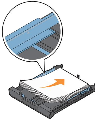
5 调节进纸导轨，使之轻轻地靠在纸张的左右两侧和底部。
