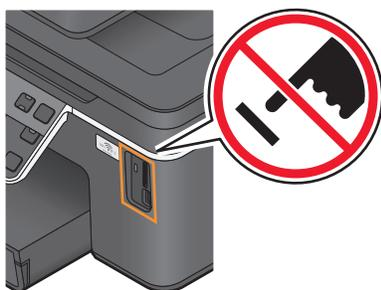
**警告—可能的损坏：**当正在打印、读取或写入蓝牙设备时，请不要触摸任何电缆、任何网络适配器、任何接口、USB 蓝牙适配器或图中所示的打印机区域，否则可能会发生数据丢失。
