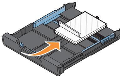
5 调节进纸导轨，使之轻轻地靠在信封或照片纸的左右两侧和底部。
