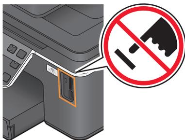
**警告—可能的损坏：**当正在从 PictBridge 兼容数码相机中打印时，请不要触摸任何电缆、任何网络适配器、任何接口、存储设备或图中所示的打印机区域，否则可能会发生数据丢失。
