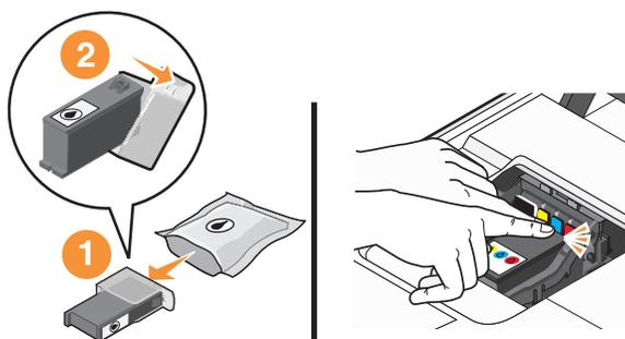
**注意：**取下保护帽后请立刻安装新的打印墨盒，以避免墨水暴露在空气中。
