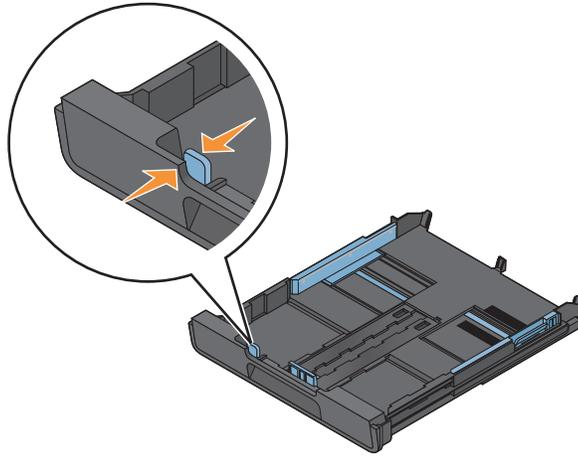
**注意：**当您拉开进纸匣时，第一个停止位置适用于 A4 尺寸的纸张。当进纸匣完全拉开时，适用于 Legal 尺寸的纸张。
