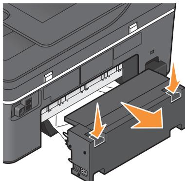
**⚠ 当心—可能的伤害：** 双面打印部件后面的区域带有突出的棱角（纸张通道的一部分）。为了避免受伤，当您为了清除卡纸而接触此区域时，请特别小心。
